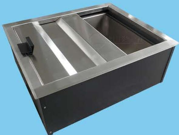
Il passagiogetti mod. "G" e' costituito da una struttura in lamiera d'acciaio verniciata a polveri. La parte superiore è rifinita con lamiera d'acciaio inossidabile e lo scorrimento del piano superiore determina lo spostamento del cassetto interno nel senso opposto. Sono provvisti di vaschetta passa-carte.
