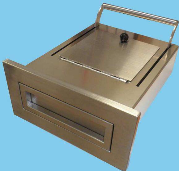
Il passaogetti modello "F-16" è realizzato interamente in lamiera di acciaio inox pressopiegata. E' indicato per infissi o pareti spessore massimo 140 mm
